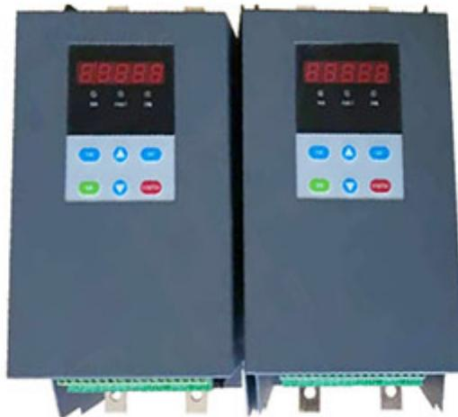
电子调压器，在国内又被称为可控硅、调功调压器、功率调整器、调相器、调功器等等，它是一种无级的电力调整设备；是工业电热行业控制利器、节能环保型产品。TAISEE SCR电力调整器：是一种以晶闸管（电力电子功率器件）为基础，以智能数字控制电路为的电源功率控制电器，简称晶闸管调功器，又称可控硅调功器，可控硅调整器，可控硅调压器，晶闸管调整器，晶闸管调压器，电力调整器，电力调压器，功率控制器。具有效率高、无机械噪声和磨损、响应速度快、体积小、重量轻等诸多优点。“晶闸管调功器”通过对电压、电流和功率的精确控制，从而实现精密控温。并且凭借其先进的数字控制算法，优化了电能使用效率。对节约电能起了重要作用。电子调整器是应用晶闸管（又称可控硅）及其触发控制电路用于调整负载功率的盘装功率调整单元。现在更多的是运用数字电路触发可控硅实现调压和调功。调压采用移相控制方式，调功有定周期调功和变周期调功两种方式。电力调整器又可分为单相电力调整器与三相电力调整器。三相电子调压器由触发板、散热器、（风扇）、外壳等组成。电流规格由28A至800A均可订制，内部模块均采用国外原装进口模块，匹配高速熔断丝，质量保证。
